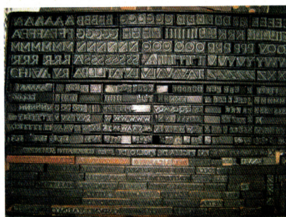
Ilustr. 19.11. Czcionki z cynkowych kłisz chemigraficznych
